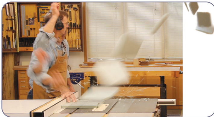
شکل ۴-۵. لگد اره (پرتاب قطعه کار به عقب در حین برش)
