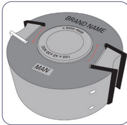
۳-۲۶. تویی‌های دارای حفاظ محدودکننده برش (Limited cutter protection)
