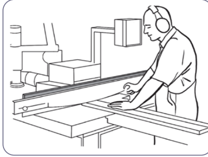
۳۰-۳. استفاده از قطعه کمکی در برش قطعات کوچک
