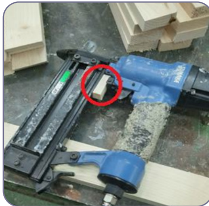
شکل ۴۰-۳. نمونه‌ای از غیرفعال کردن ضامن میخکوب
