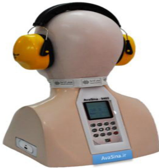
مانکن سر و نیم‌تنه AvaSina 9402 در حالت تست حفاظت‌های روگوشی
