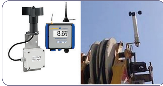
شکل ۳-۱۷. نمونه‌های از یادسنج‌های نصب شده بر روی جرثقیل‌ها
