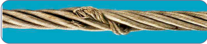
شکل ۳-۴۷. آسیب حرارتی سیم بکسل
