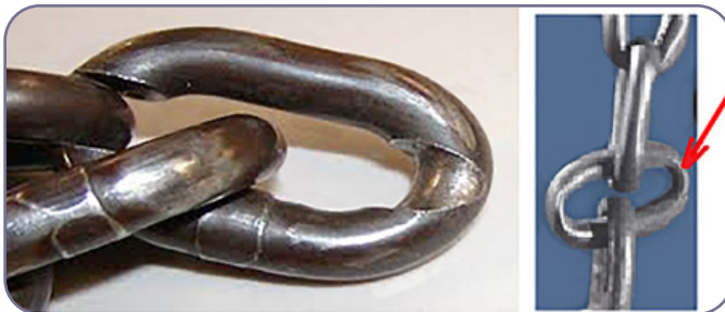
شکل ۳-۶۳. سایش حلقه‌های زنجیر
