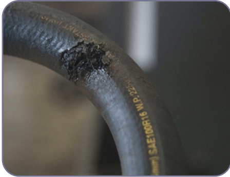
شکل ۳-۱۹. آسیب شیلنگ هیدرولیک
