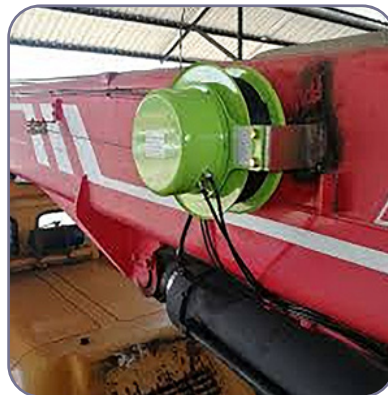
شکل ۳-۱۶. سنسور اندازه‌گیری طول بوم
