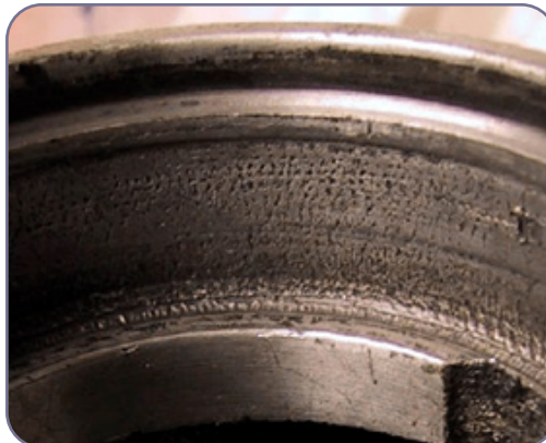
شکل ۳-۹. سایش رینگ پلرینگ
