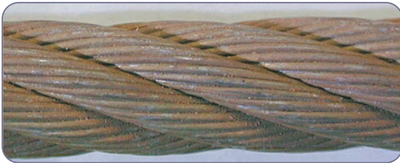
شکل ۳-۴۰. آثار روی سطح خارجی (نرخ شدت آسیب صفر)
