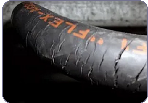
شکل ۳-۱۹. آسیب شیلنگ هیدرولیک
