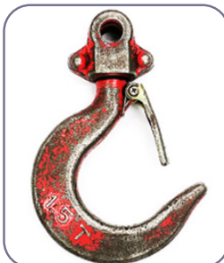
شکل ۳-۵۶. بازشدگی دهانه قلاب جرتقیل
