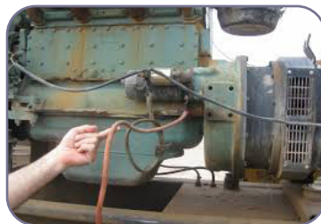
شکل ۱-۱. وجود سیم فرسوده و نالیمن ماشین‌آلات
