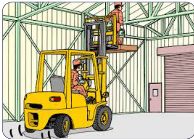
شکل ۱۰-۱. سوار کردن کارگر بر روی شاخک لیفتراک
