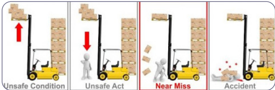
شکل ۱-۴. نمونه‌ای از تفاوت شرایط ناایمن، عمل ناایمن، شبه حادثه و حادثه (حمل بار با لیفتراک)
