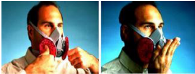
شکل ۶.۱۵. آزمایش کیپ بودن رسپیراتور: سمت راست آزمایش فشار مثبت سمت چپ آزمایش فشار منفی
