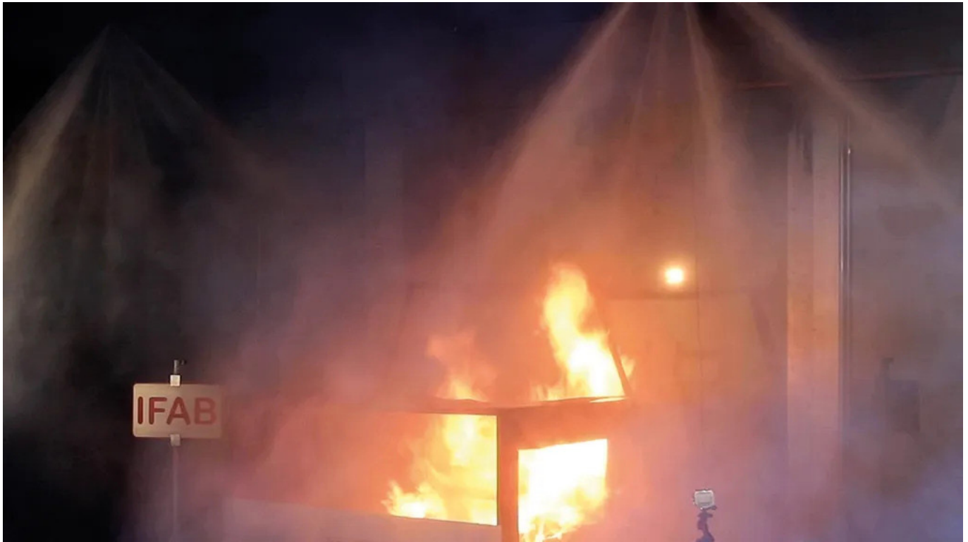
فعال‌سازی واترمیست در تست آتش‌سوزی SUVEREN با وسیله نقلیه الکتریکی
