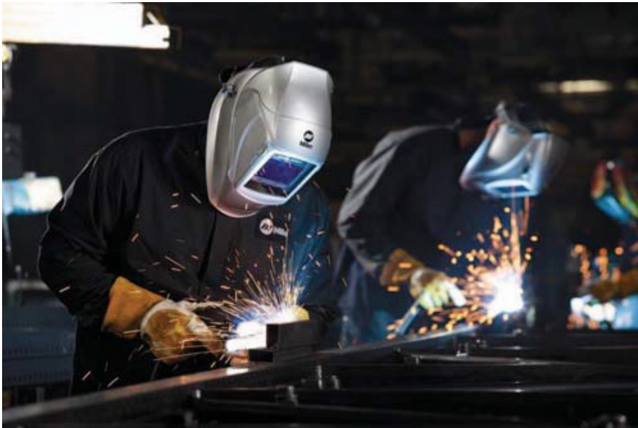
شکل ۷-۱: لباس‌های حفاظتی معمولی برای جوشکاری قوس
