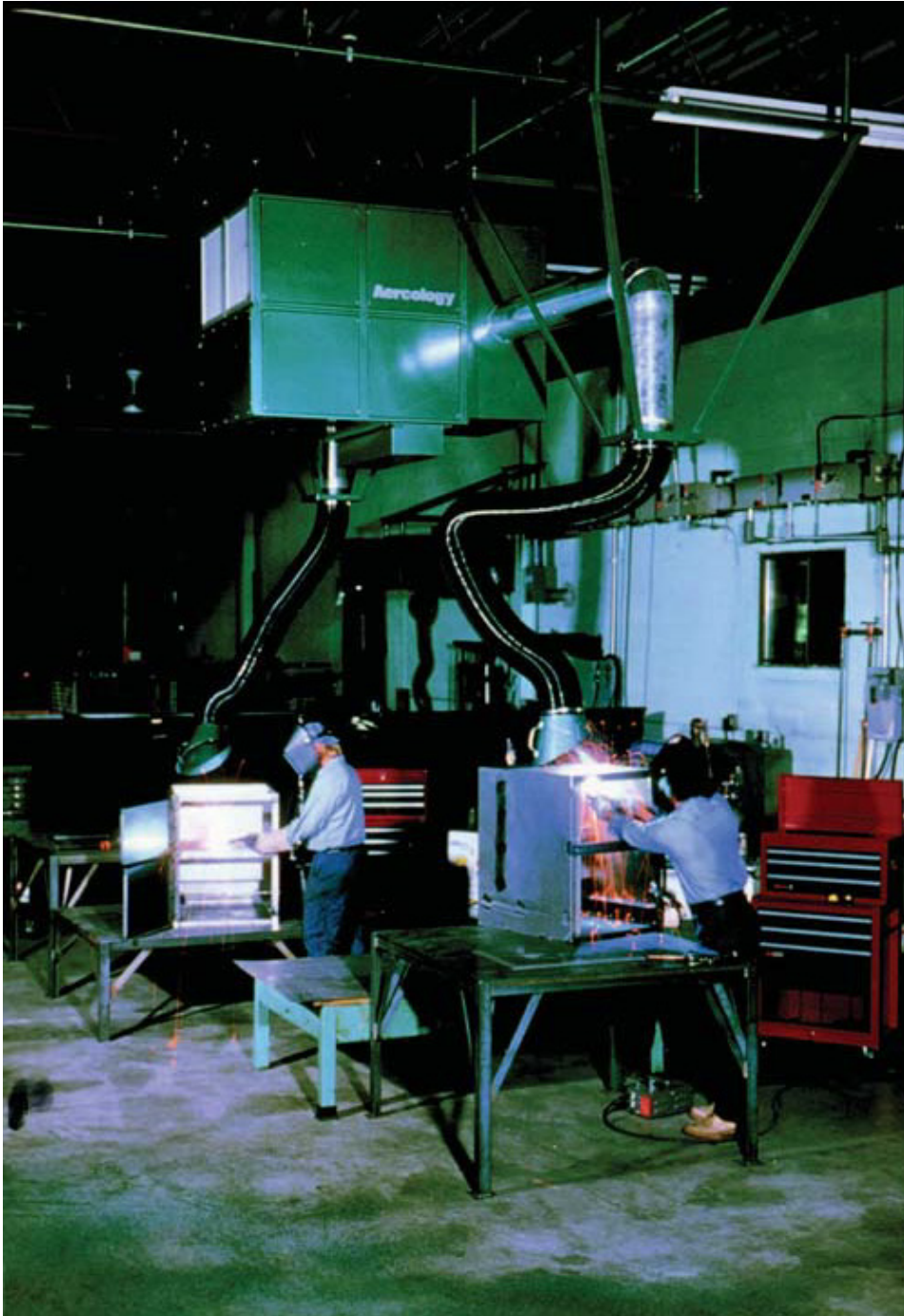
شکل ۱۴-۱: هودهای متحرک در نزدیکی قوس‌های جوشکاری قرار گرفته‌اند
