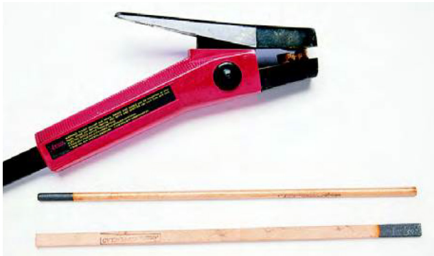
شکل ۱-۱۱: الکتروگیر و الکترودهای به‌کاررفته در فرایند برشکاری با الکترو کربنی و هوا
