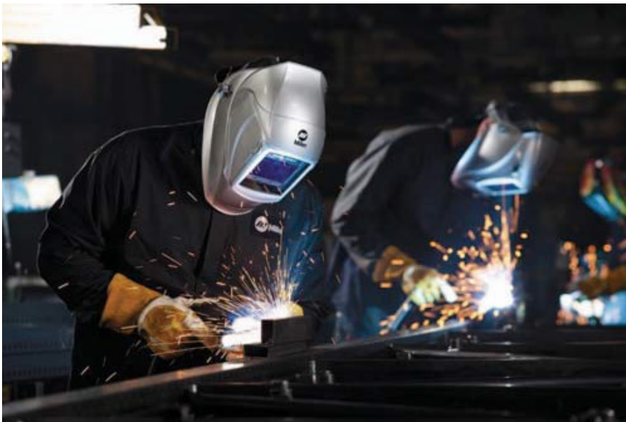
شکل ۷-۱: لباس‌های حفاظتی معمولی برای جوشکاری قوس
