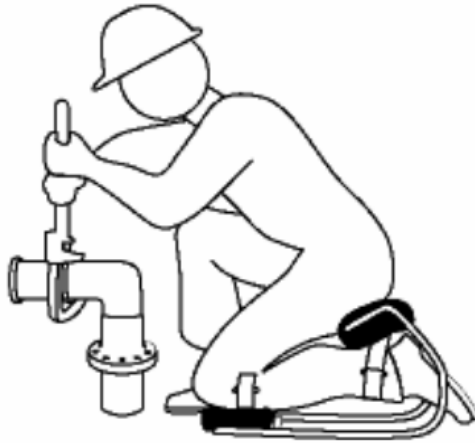
شکل ۹-۴: صندلی برای جوشکاری در وضعیت زانو زده
