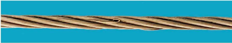
شکل ۳-۴۴. بیرون زدگی سیم از سیم بکسل
