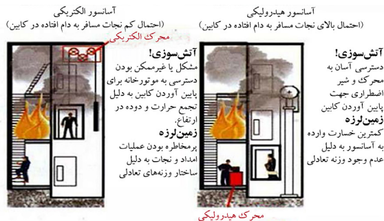
شکل ۴-۱۶. مقایسه آسانسورهای هیدرولیکی و کششی هنگام آتش‌سوزی و زلزله
