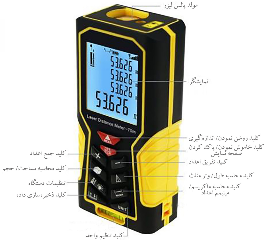
شکل ۴-۱۹. تجهیزات بازرسی آسانسور: (الف) متر نواری؛ (ب) متر لیزری
