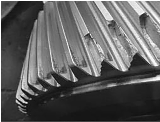
شکل ۳-۷۱. ترک دندانچه چرخدنده: (الف) در مراحل اولیه؛ (ب) جداسدن دندانچه
