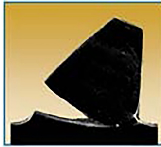
شکل ۳-۷۲. شکستگی دندانچه چرخنده از (الف) ریشه؛ (ب) پهلو
