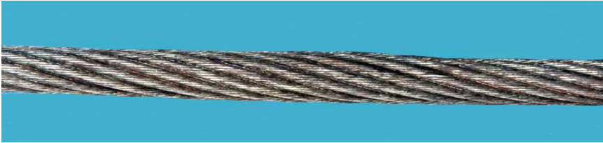
شکل ۳-۴۱. افزایش قطر سیم بکسل بر اثر تغییر شکل هسته
