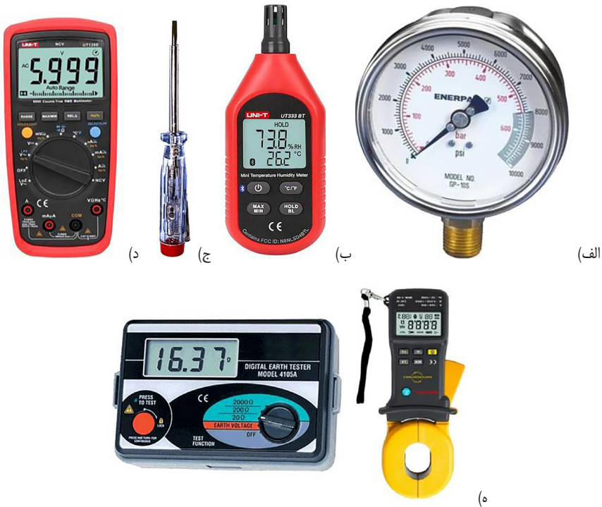
شکل ۴-۲۶. تجهیزات بازرسی آسانسور: الف) فشارسنج؛ ب) دما/رطوبت‌سنج؛ ج) فازمتر؛ د) مولتی‌متر؛ ه) ارت‌سنج
