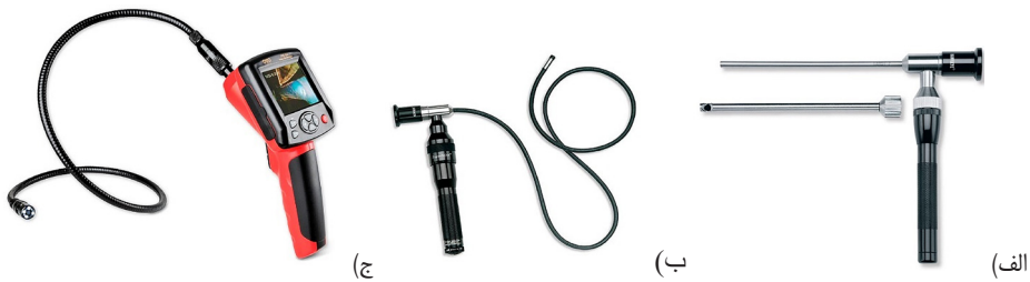
شکل ۴-۲۴. تجهیزات بازرسی آسانسور: الف) بروسکوپ صلب؛ ب) بروسکوپ انعطاف‌پذیر؛
