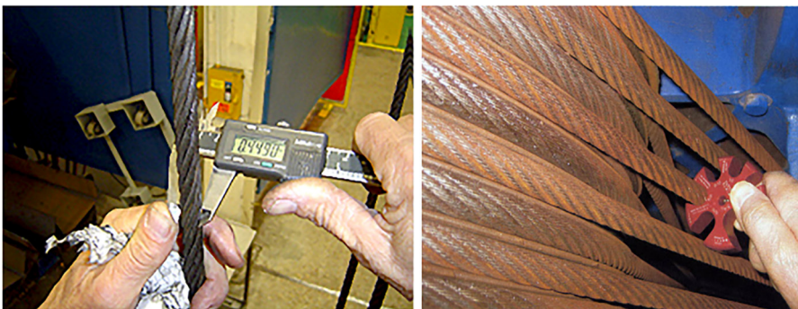
شکل ۳-۳۳. اندازه‌گیری قطر سیم‌بکسل
