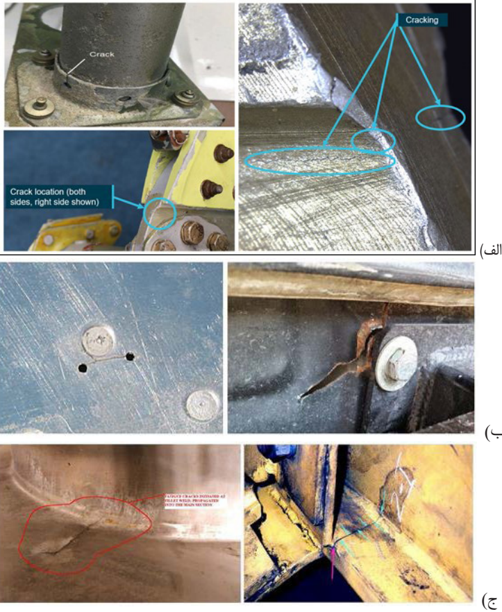
شکل ۳-۴. نمونه‌هایی از رشد ترک: (الف) تغییر ناگهانی هندسی؛ (ب) اطراف اتصالات؛ (ج) نواحی جوشکاری
