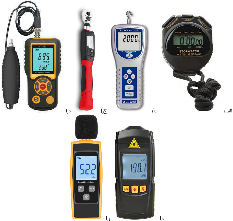
شکل ۴-۲۵. تجهیزات بازرسی آسانسور: الف) کرنومتر؛ ب) نیروسنج؛ ج) تورکومتر؛ د) لرزش‌سنج؛ ه) تاکومتر؛ و) صوت‌سنج
