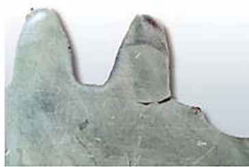
شکل ۳-۷۱. ترک دندانچه چرخدنده: (الف) در مراحل اولیه؛ (ب) جداسدن دندانچه
