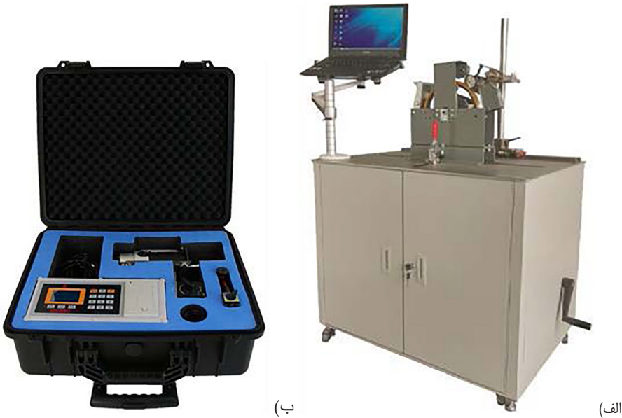
شکل ۴-۲۹. آزمون فنی گاورنر آسانسور: الف) نوع ثابت؛ ب) نوع قابل حمل
