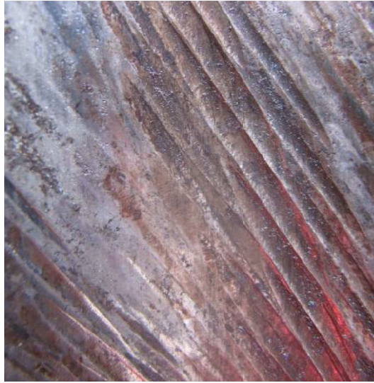
شکل ۳-۵۷. رد اثر سیم‌بکسل روی قرقره
