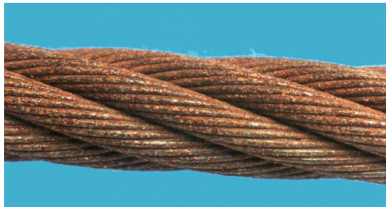
شکل ۳-۳۶. خوردگی سیم‌بکسل: الف) زنگ‌زدگی خارجی؛ ب) زنگ‌زدگی داخلی
