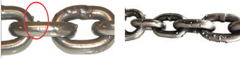
شکل ۳-۴۹. آثار پاشش جوش بر روی حلقه‌های زنجیر
