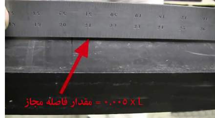
شکل ۵-۵: نحوه اندازه‌گیری میزان خم‌شدگی در شاخک
