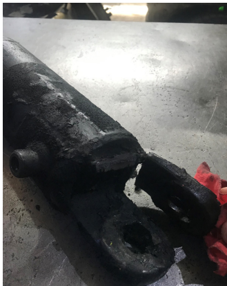
شکل ۳۵-۵: شکست سیلندر هیدرولیک کج‌کننده دکل در محل اتصال به شاسی
