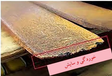
شکل ۵-۱۰: دو نمونه آسیب دیدگی در نوک شاخک
