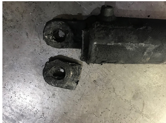
شکل ۳۵-۵: شکست سیلندر هیدرولیک کج‌کننده دکل در محل اتصال به شاسی
