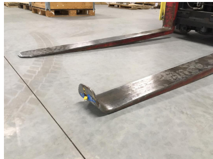
شکل ۵-۱۰: دو نمونه آسیب دیدگی در نوک شاخک
