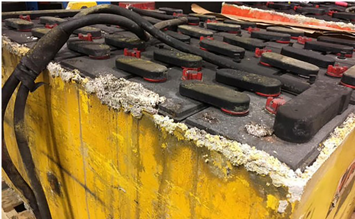
شکل ۵-۴۸: رسوب در باتری بر اثر وجود مایع الکترولیت در محفظه باتری
