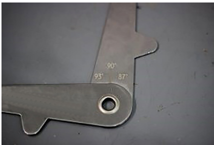
شکل ۶-۱۰: نحوه اندازه‌گیری زاویه در پاشنه شاخک با استفاده از کالیپر شاخک
