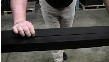
شکل ۵-۵: نحوه اندازه‌گیری میزان خم‌شدگی در شاخک
