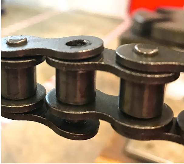
شکل ۵-۱۵: بیرونزدگی بین زنجیر
