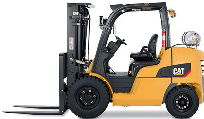
شکل ۲-۶: لیفتراک با تایر بادی و موتور احتراق داخلی گازسوز
