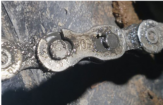
شکل ۵-۱۴: شکستگی در ورق جانبی زنجیر
