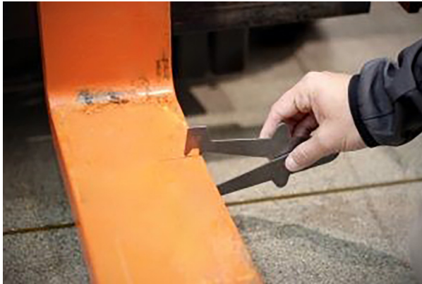
شکل ۶-۱۲: نحوه اندازه‌گیری میزان سایش در پاشنه شاخک
