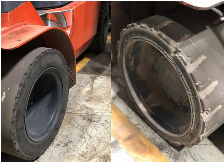
شکل ۵-۲۳: سایش و از بین رفتن عاج تایر
