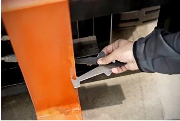
شکل ۶-۱۱: نحوه اندازه‌گیری ضخامت ساقه شاخک با استفاده از کالیپر شاخک
