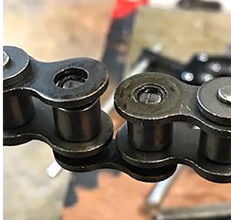
شکل ۵-۱۳: عدم وجود ورق جانبی در زنجیر
