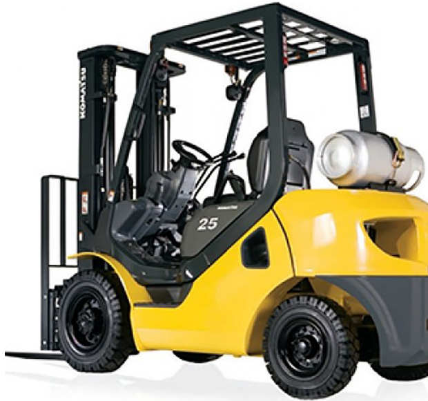
شکل ۱-۶: لیفتراک تایر صلب با موتور احتراق داخلی گازسوز
