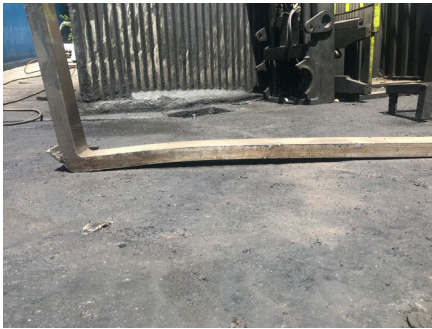
شکل ۵-۶: یک نمونه شاخک با خم‌شدگی بیشتر از حد مجاز
