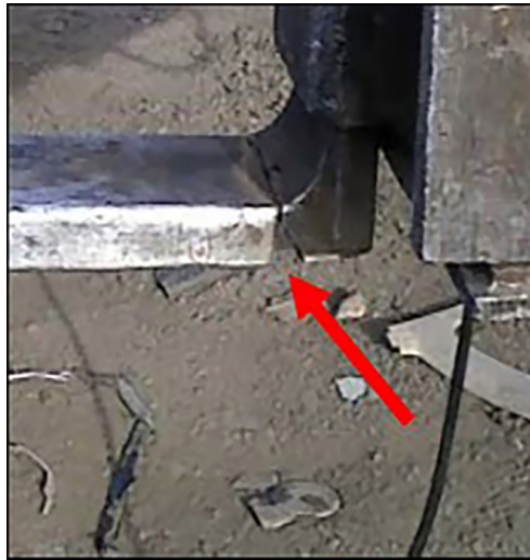
شکل ۸-۵: ترک در ناحیه پاشنه شاخک
