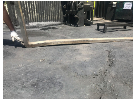
شکل ۵-۶: یک نمونه شاخک با خم‌شدگی بیشتر از حد مجاز
