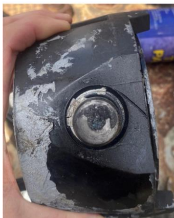
شکل ۲: فشار سنج مسدود شده مربوط به حادثه
